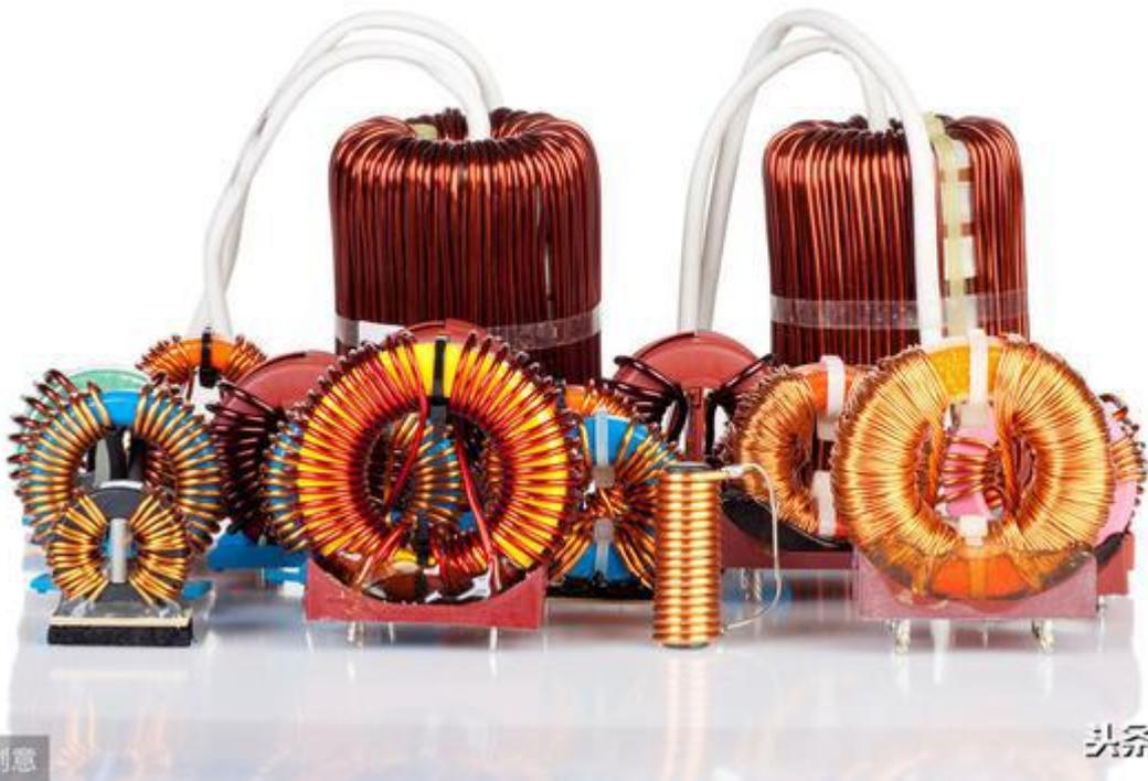
使用不合适的滤波器会破坏信号,这种滤波器在信号频率范围内的差模插入损耗较高或与传输线路阻抗不匹配。因此,请不要选择在插入前会影响信号质量的滤波器。
